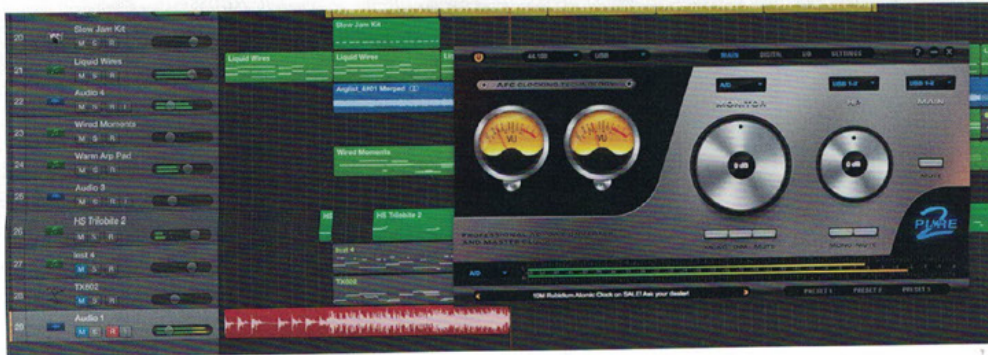
So sieht es aus, wenn man unter Logic Pro X den Mix in Stereo ausspielt, im Pure 2 einen analogen Prozessor einschleift, und das Resultat wiederum mit Logic mit-schneidet.
