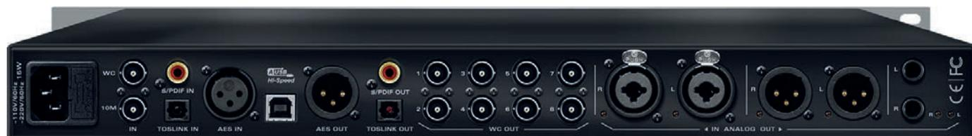
Die Rückseite des Pure2 bietet neben analogen und digitalen Audio-Verbindungen auch acht Word-Clock-Outs zur Synchronisierung anderer Geräte.
